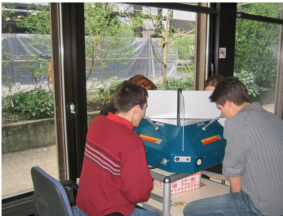
Probanden riechen im Labor in einer neutralen Umgebung an den Proben. So lässt sich vermeiden, dass sie durch sicht- oder hörbaren Kontext beeinflusst werden.
