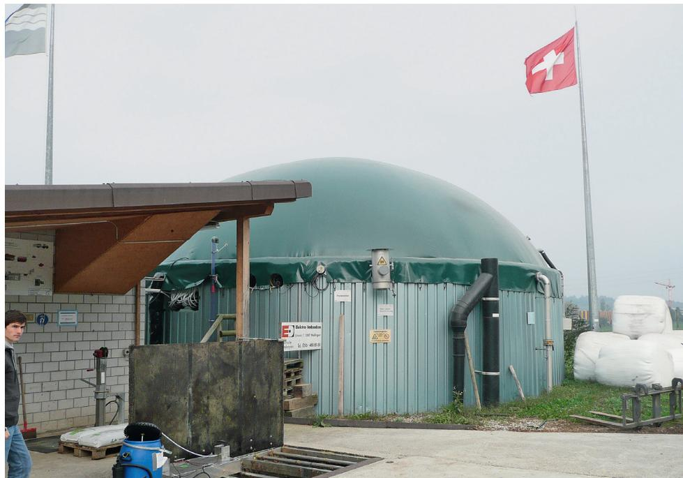
Geruchsprobenahme bei der Vorgrube einer Biogas-Anlage. Im blauen Fass im Vordergrund befindet sich der Beutel, der mich geruchsbelasteter Luft gefüllt wird.
