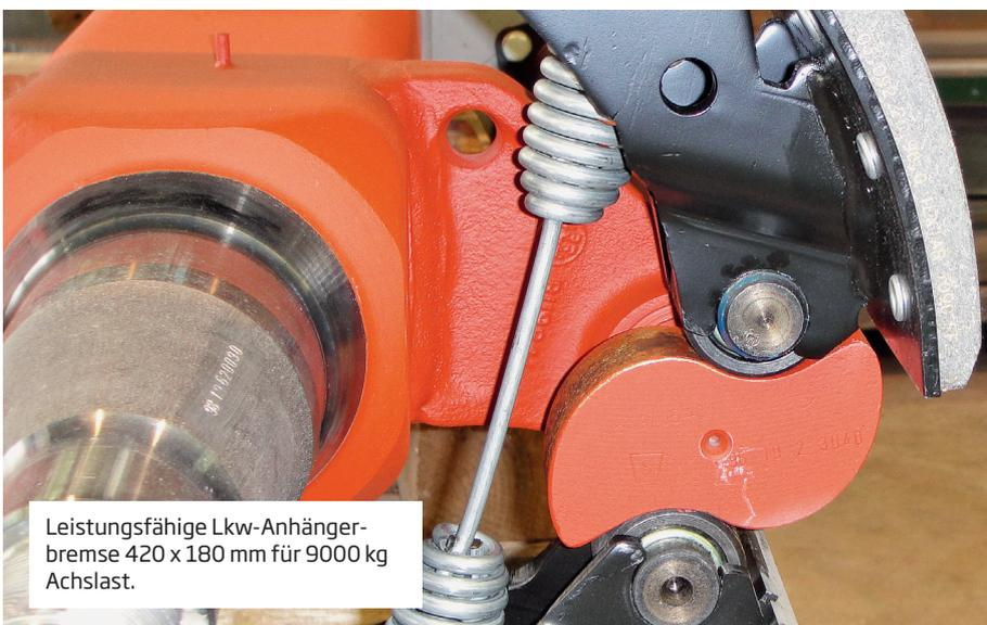
Leistungsfähige Lkw-Anhängerbremse 420 x 180 mm für 9000 kg Achslast.
